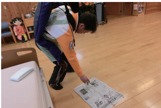
排泄助中に床に置いた陰洗ボトルを取ろうとすると、足パッドが邪魔になる
